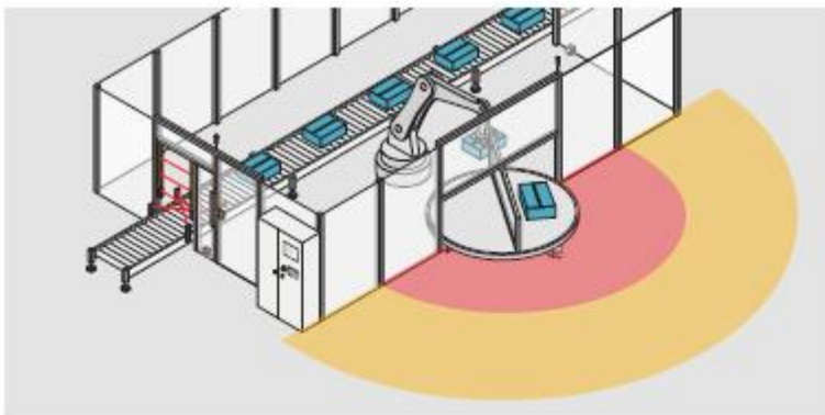
Proteção de áreas de perigo estacionárias
